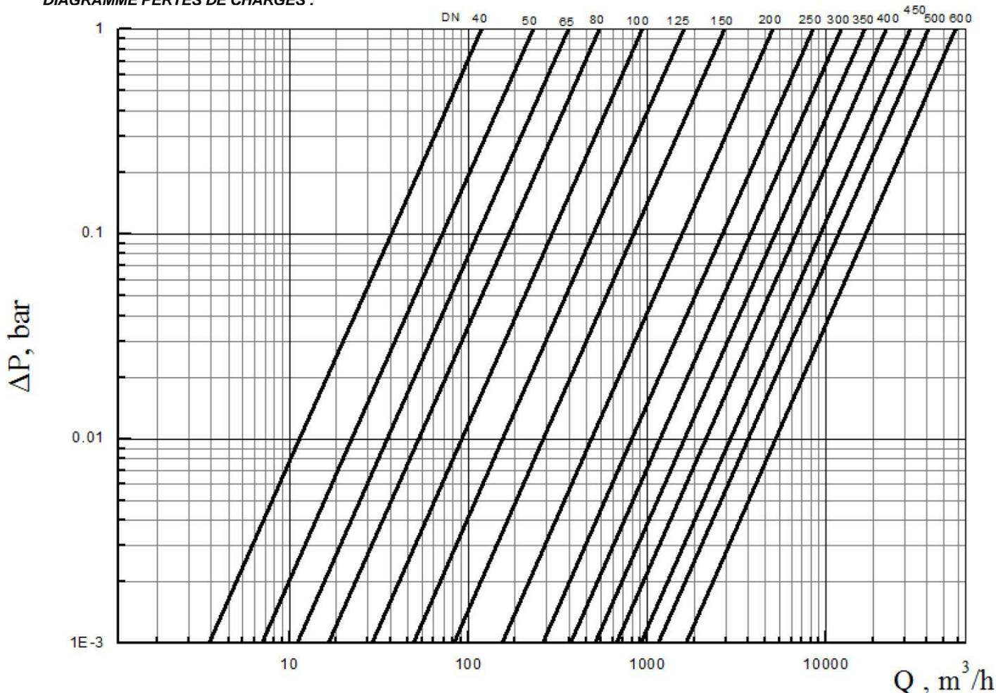
**VANNE A OPERCULE CAOUTCHOUC PN10/16 DIN COURT 3202-F4 FAH EPDM ACS**
