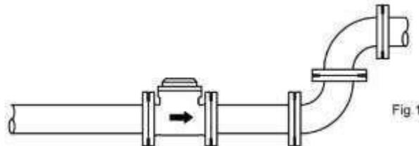
Respecter le sens de passage indiqué sur le corps par une flèche.
