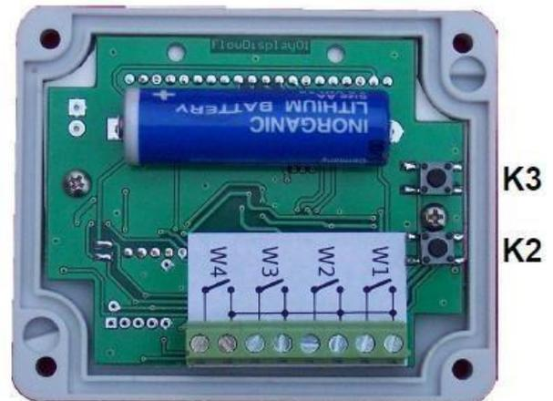
L'afficheur est équipé de 3 boutons, K1 en façade permet de visualiser la consommation de chaque compteur. Les boutons K2 et K3 sont accessibles une fois la façade démontée.
