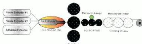
Contrairement aux techniques traditionnelles de laminage, ce procédé permet d'obtenir un produit homogène, sans interface, en conséquence de quoi aucune délamination n'est possible.
